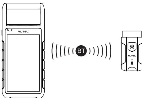
2. 通过蓝牙匹配将VCI与BT608连接。检查屏幕右上角的VCI图标。如连接成功,图标上会出现绿色的“√”符号。
