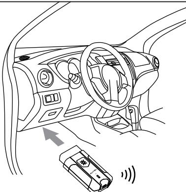
1. 长按锁屏/电源按钮开启设备。选择需要的功能,按照屏幕指引操作。将VCI插入车辆的OBD II接口,接口一般位于车辆仪表盘下方。
