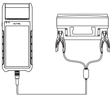
2. 使用红色夹钳夹住电池正极(+), 黑色夹钳夹住电池负极(-)。
