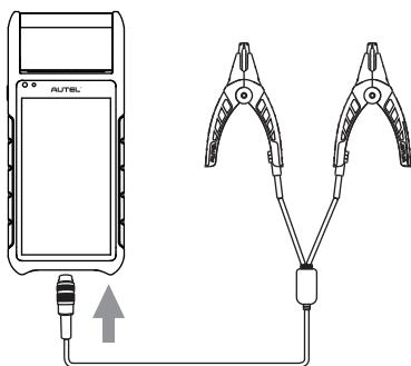
1. 将电池夹钳通过夹钳接口与BT608连接。
