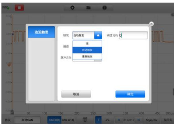
图 9-126 触发模式示意图
