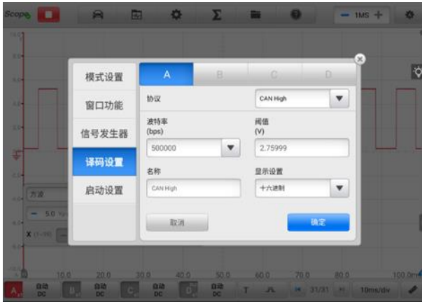
图 9-24 “译码设置” 界面示意图 1
