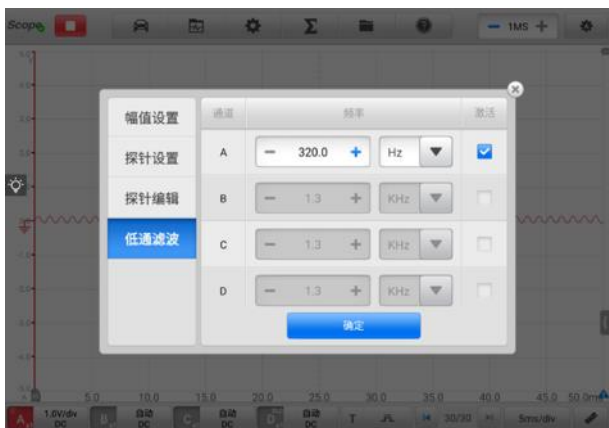
图 9-50 低通滤波界面示意图
